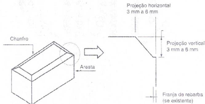
Figura 1 – Chanfro de uma peça de concreto
