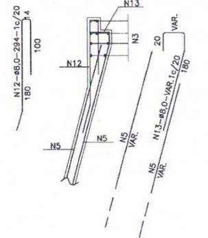
SEÇÃO DA VIGA DE TOPO DA LAJE INFERIOR (2X)
