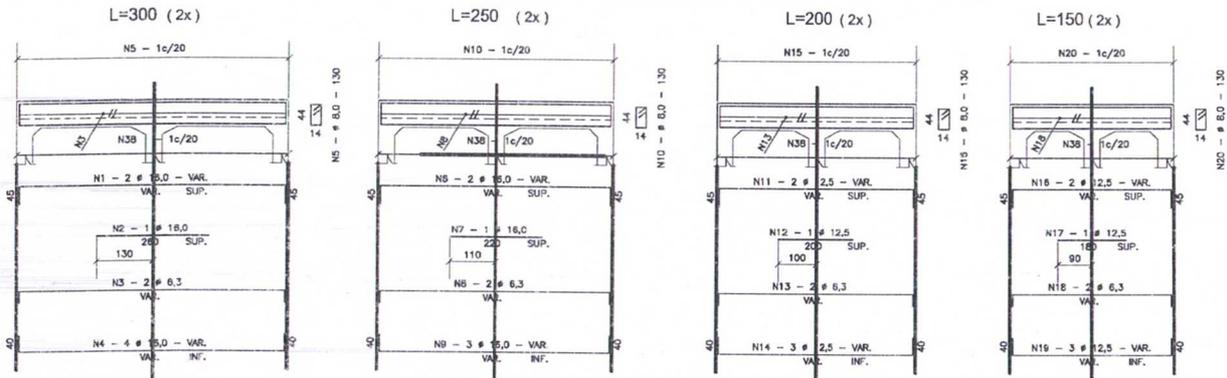
VIGA DE TOPO DA LAJE SUPERIOR -  $\alpha = 0^\circ$  e  $15^\circ$
